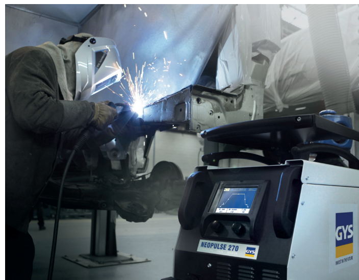
En réparation, le soudage de l'aluminium à l'aide d'un poste semi-automatique est possible uniquement pour la fermeture d'un assemblage suite à une coupe partielle dans des conditions très encadrées. Pour le reste, on utilise la technique du rivetage/collage.
