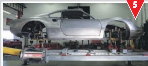
Réparation et création d'éléments du châssis.
