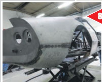
La partie inférieure de l'aile arrière et de sa jupe est remplacée.
