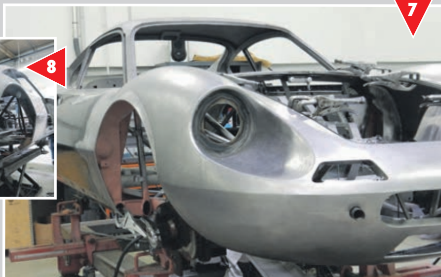
L'ensemble de la tôlerie a été mis à nu avant les travaux de formage.
